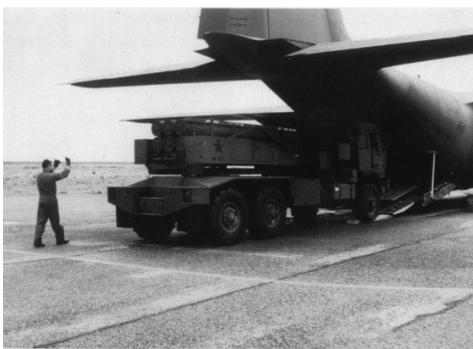
Рис. 4. Погрузка РСЗО HIMARS на борт транспортного самолета C-130
