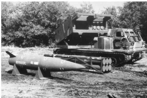
Рис. 1. Пусковая установка, контейнер с шестью НУРС и ракета системы АТАСМС
