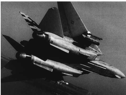
Рис. 2. Самолет F-14 «Томкэт», оборудованный прицельно-навигационной системой LANTIRN
