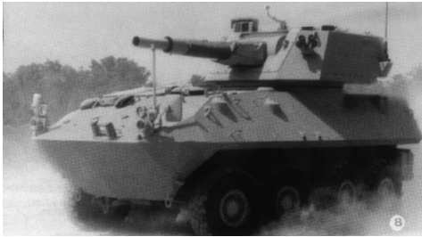
Рис. 3. 120-мм миномет на базе колесного БТР «Пирана»
