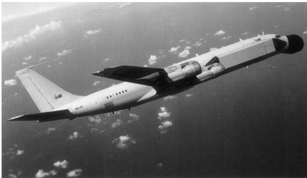
Рис. 2. Самолет Боинг 707, оснащенный системой ДРЛО и управления «Фалкон»
